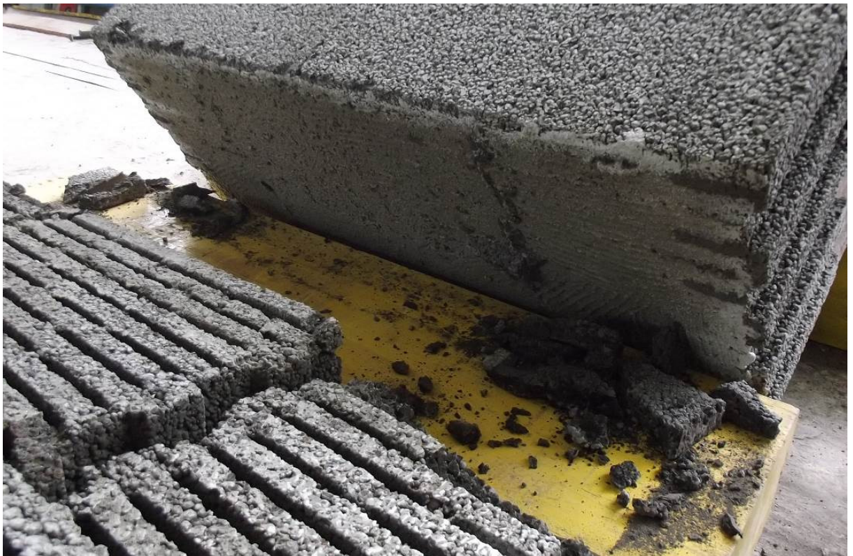
Рисунок 6.4 - Характер разрушения образцов каменной кладки при изгибе по неперевязанному сечению
