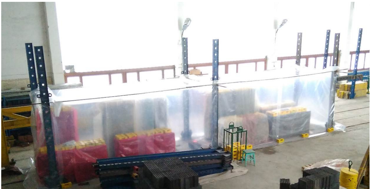
Рисунок 5.2 – Предварительное обжигание и хранение опытных образцов каменной кладки
